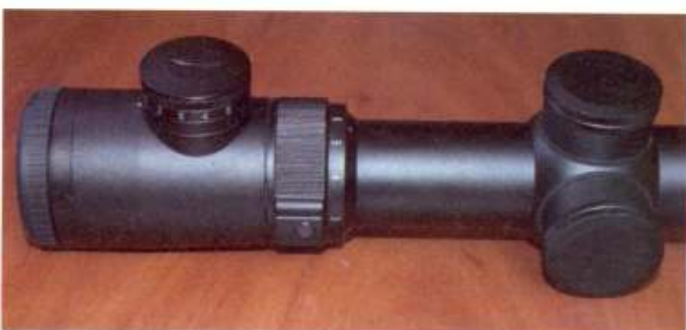
Bębny regulacyjne, mechanizm zmiany krotności i podświetlania
